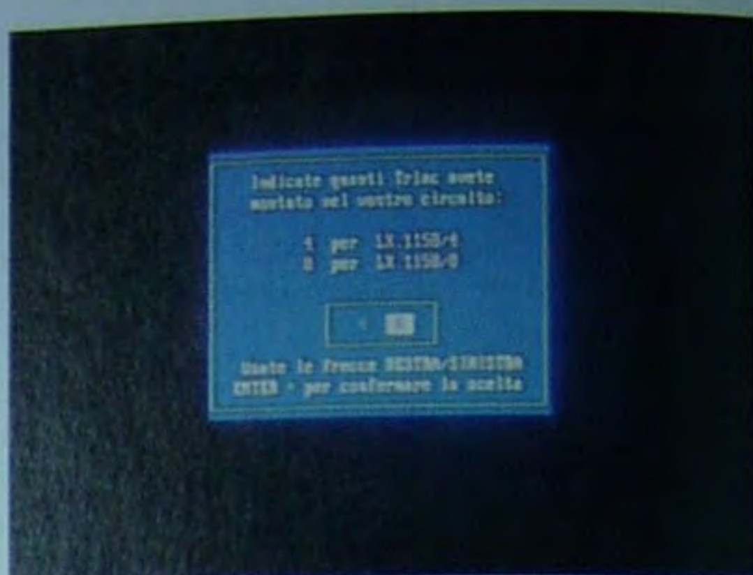
Fig.7 Per ogni programma il computer vi chiederà quanti Triac sono presenti nella vostra scheda LX.1158, cioè se 4 o 8.
