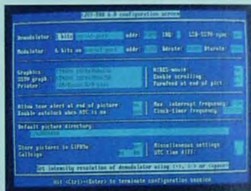
Fig.4 Settate scheda grafica e COM, dovrete solo aggiornare l'orario UTC. Se l'orario è solare nella riga UTC time dovrete scrivere 1, se è legale dovrete scrivere 2.
