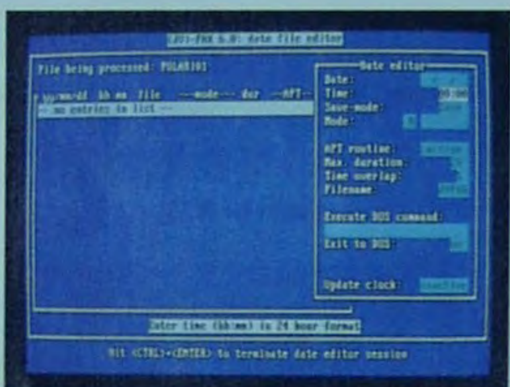
Fig.26 Dopo aver premuto Enter premete nuovamente F2 e nella finestra che appare dovete scrivere tutti i parametri riportati nell'articolo. Per confermare Ctrl + Enter.
